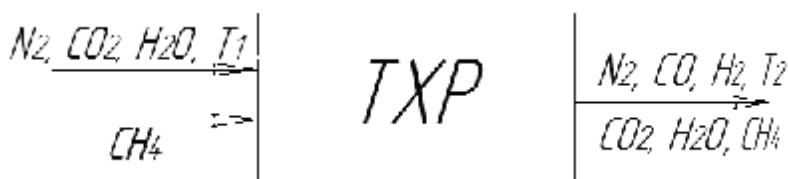
Рис. 1. Схема преобразования веществ в термохимическом реакторе
