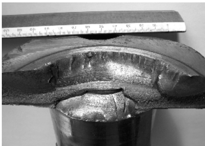
Рис. 1. Форма усталостного разрушения коленчатого вала по щеке
