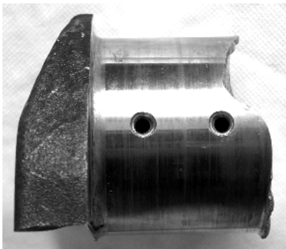
Рис. 5. Характер разрушения шейки коленчатого вала в результате эксплуатационных испытаний
