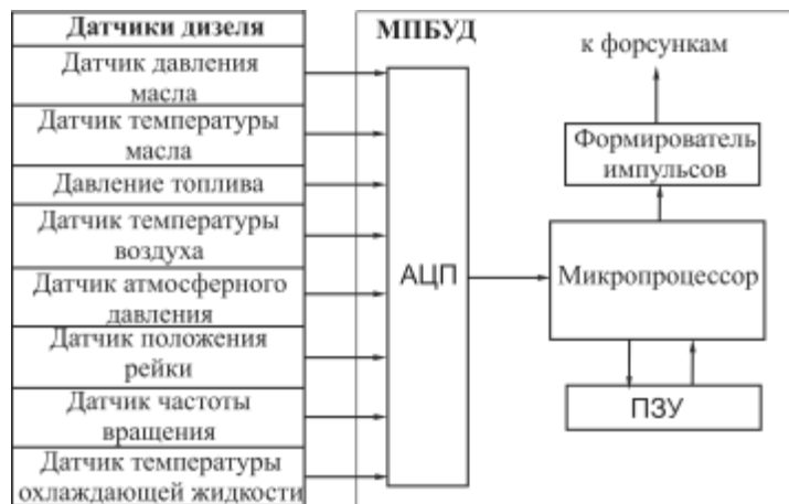
Рис. 2. Структурная схема электронного управления подачей топлива
