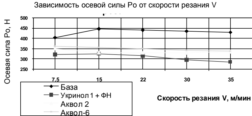
Рис. 4. Влияние СОТС и скорости резания на осевую силу P_o при сверлении стали 40X (P6M5, \varnothing = 9,6 мм, S = 0,1 м/мин)
