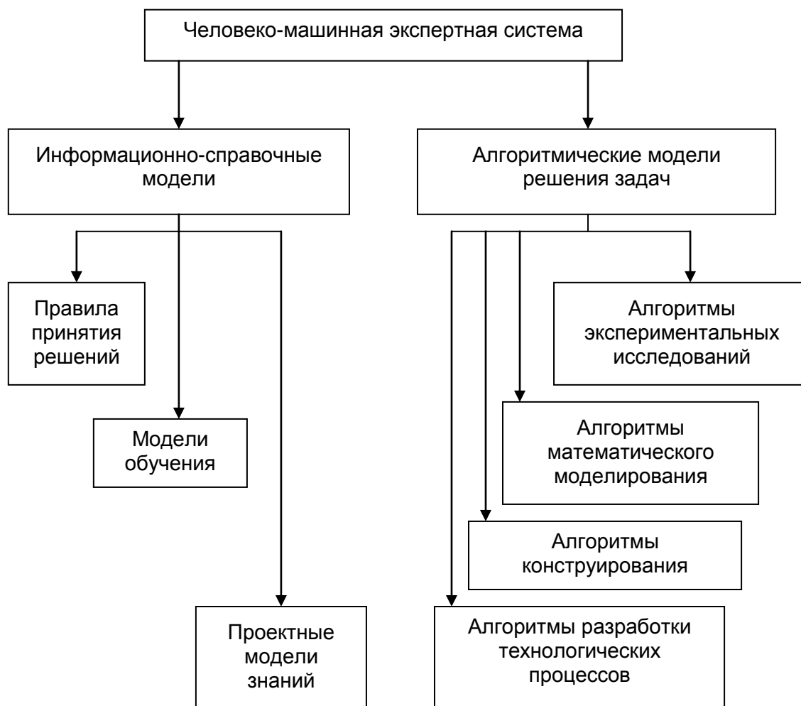
Рис. 3. Структурная схема человеко-машинной экспертной системы
