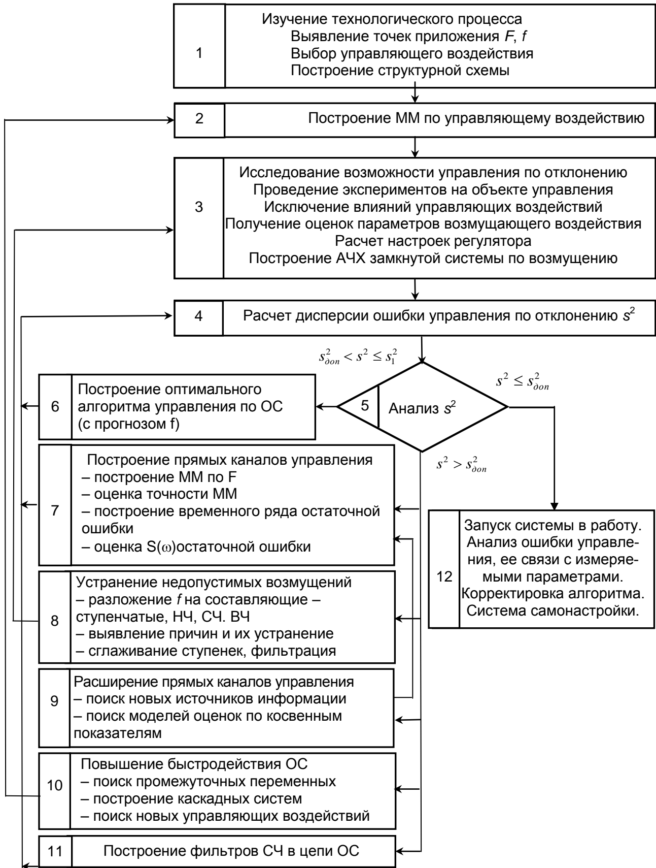
Рис. 6. Блок-схема процесса решения расширенной задачи управления
