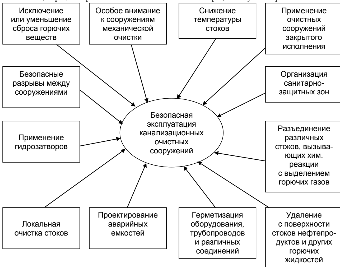
Схема основных факторов, снижающих взрывопожарную опасность канализационных очистных сооружений
