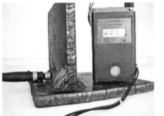
Рис. 3. Схема практического применения ультразвукового толщиномера УТ-93П для выявления трещин во внутреннем сварном шве РВС, заполненного нефтепродуктом
