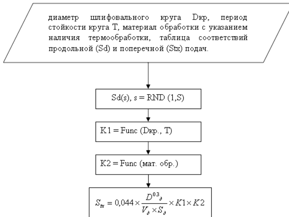
Рис. 2. Блок-схема определения режимов резания при круглом наружном чистовом шлифовании
