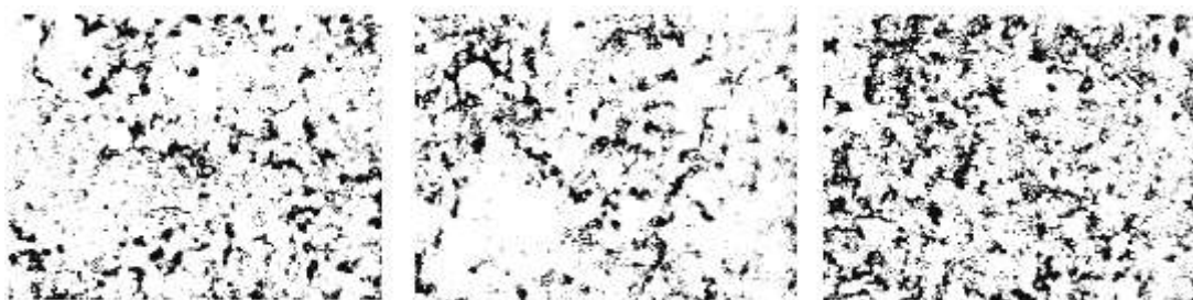
Рис. 3. Морфология электроплазменных фторгидроксиапатитовых покрытий, нанесенных при различных режимах: а – L=90 мм, \Delta>100 мкм; б – L=120 мм, \Delta<70 мкм; в – L=90 мм, \Delta<70 мкм
