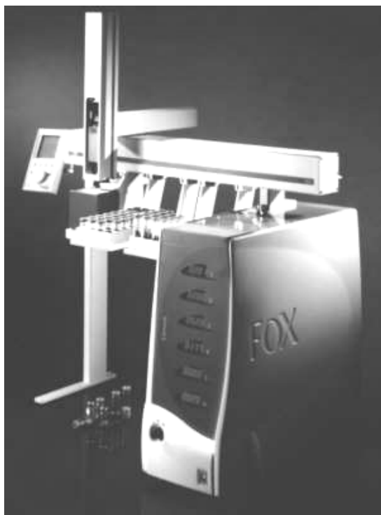
Рис. 2. Прибор типа «электронный нос» фирмы Alpha-MOS (Франция), модель FOX
