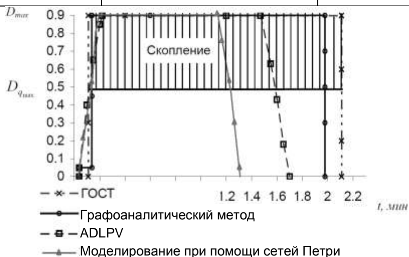
Рис. 3. Динамика расчета скопления людей перед проемом по формулам ГОСТ, графоаналитическим методом, при помощи модели ADLPV и сетей Петри
