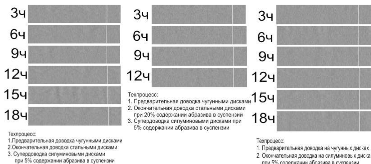
Рис. 4. Вихретоковое сканирование поверхностей шаров при различных технологических процессах и времени доводки
