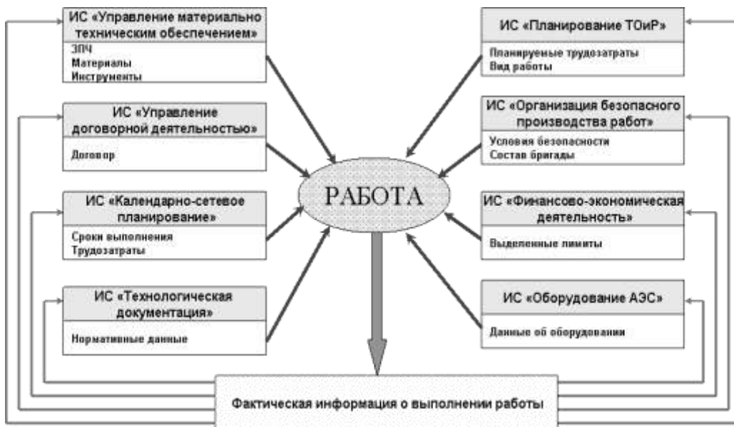
Рис. 5. Информационная схема анализа ремонтного обслуживания
