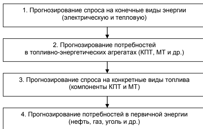
Рис. 4. Последовательность разработки прогнозов спроса на энергоносители
