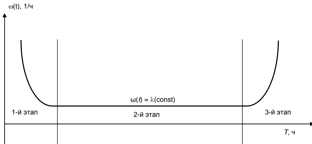
Рис. 1. Характерная зависимость интенсивности отказов \omega(t) от времени наработки изделия в эксплуатации
