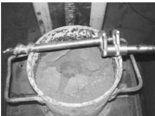
Рис. 1. Опытный образец нового винтового органа и форма с грунтом после проведения эксперимента на грунте средней прочности
