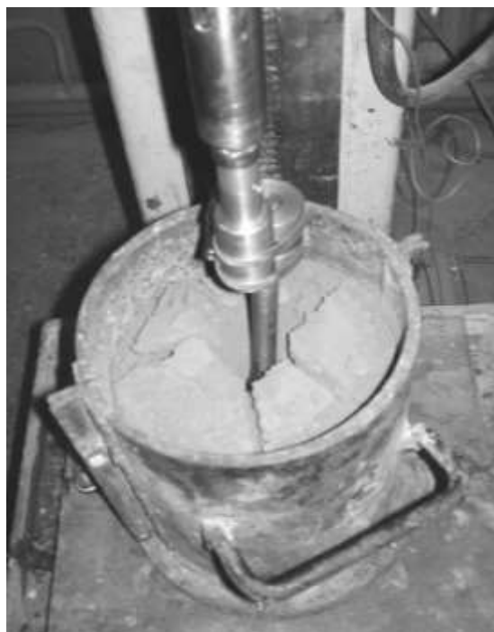
Рис. 2. Винтовой рабочий орган при погружении в мерзлый грунт
