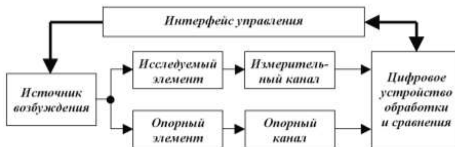
Структура двухканального цифрового формирователя – измерителя импеданса
