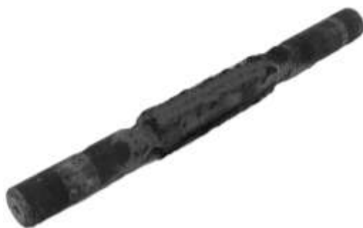
Рис. 4. Специальный образец для испытания на усталость, выполнен из стали 09Г2С с 7%-м коррозионным поражением, с применением сварки электродом УОНИ 13/55
