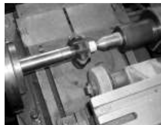
Рис. 1. Дисковая фреза и её затылование
