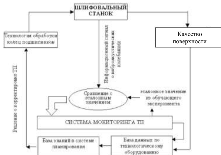
Схема формирования автоматизированной оценки динамического состояния станка и ее использование в ТПП
