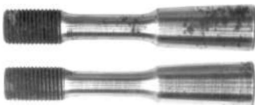
Рис. 2. Образцы для исследования сопротивления усталости материала шатунов
