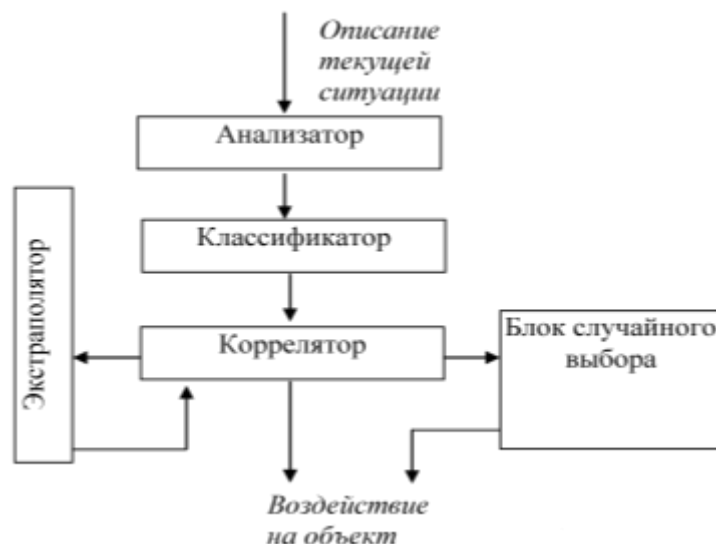
Рис. 2. Общая схема решения задачи ситуационного управления
