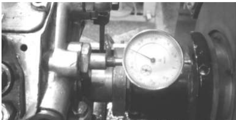
Рис. 2. Установка на ТНВД устройства для определения выхода рейки
