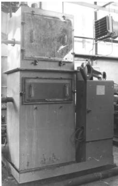
Рис. 1. Установка ГДЭУ-5 для дифференцированного гидродробеструйного упрочнения шатуна
