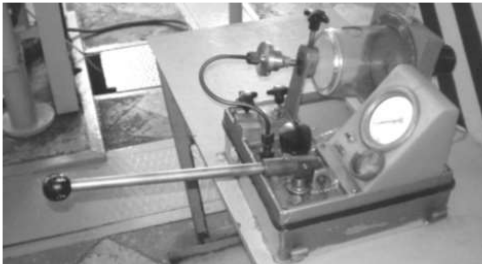
Рис. 1. Стенд проверки и регулировки форсунок, оборудованный приспособлением для регулировки усилия предварительной затяжки пружины нагнетательного клапана
