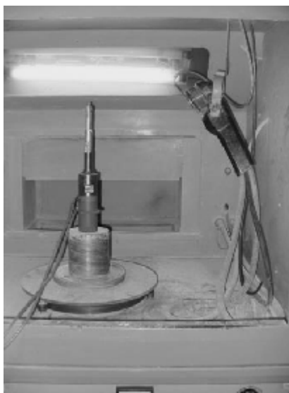
Рис. 1. Общий вид камеры напыления с ультразвуковым преобразователем установки плазменного напыления ВРЕС 744.3227.001
