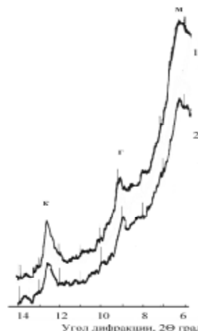
Рис. 4. Дифрактограммы образцов глин с добавками углеводов: 1 – добавка сахарозы 5%; 2 – добавка глюкозы 5%: М – монтмориллонит; К – каолинит; Г – гидрослюда
