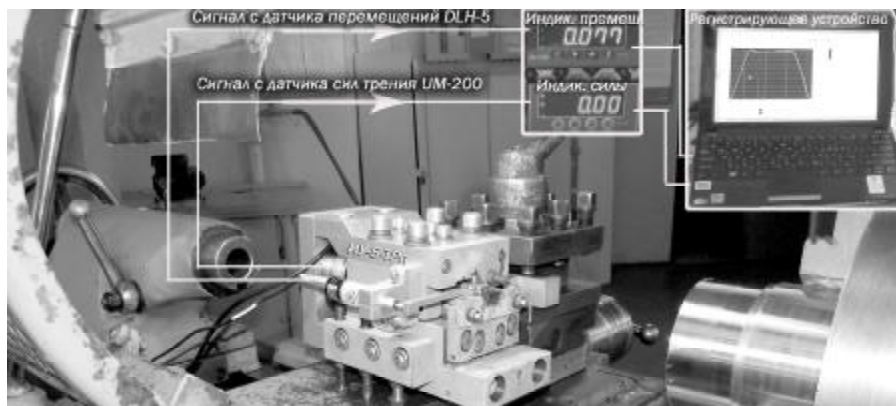
Рис. 2. Устройство для измерения сил трения и длин контактов при резании материалов
