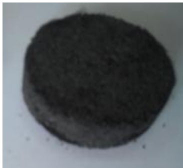
Рис. 2. Спеченный композиционный фильтр состава НСВГ+ХСВ (1:3)
