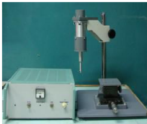
Рис. 2. Экспериментальная установка для изучения микрорезания на малых скоростях
