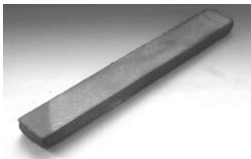
Рис. 3. Суперфинишный проектируемый брусок из электрокорунда белого марки 25А зернистости М7 с гранулированной структурой
