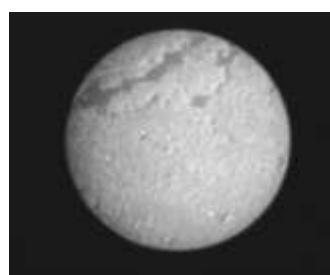
Рис. 10. Поверхность опытного гранулированного бруска после обработки с СОЖ, микроскоп МБС-9 (увеличение 40×)
