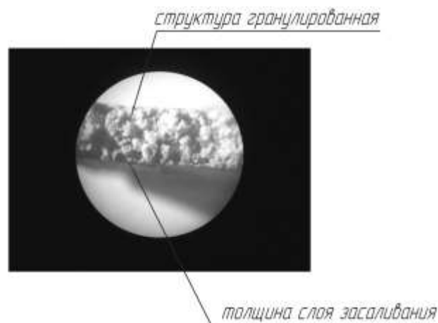
Рис. 11. Торцевой срез гранулированного бруска, микроскоп МБС-9 (увеличение 24×)
