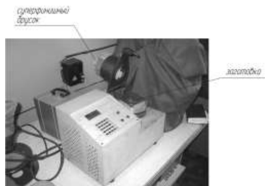
Рис. 6. Установка для определения абразивной и режущей способности шлифматериалов «Шлиф»
