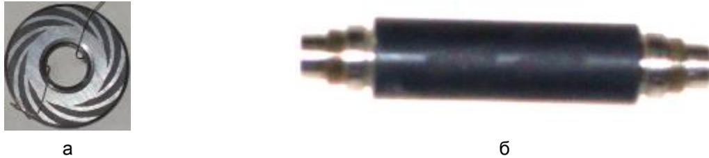
Рис. 1 Детали газодинамической опоры с плазмонапыленной поверхностью контакта:
