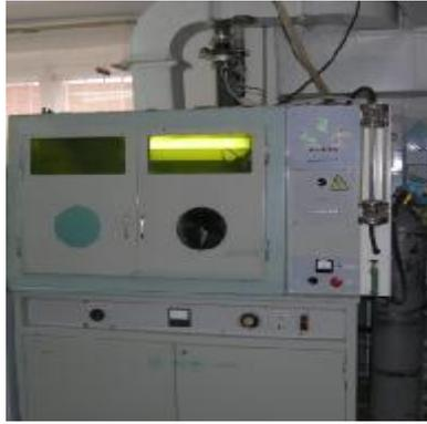
Рис. 6. Установка электроплазменного напыления порошковых материалов ВРЭС 744.3227.001
