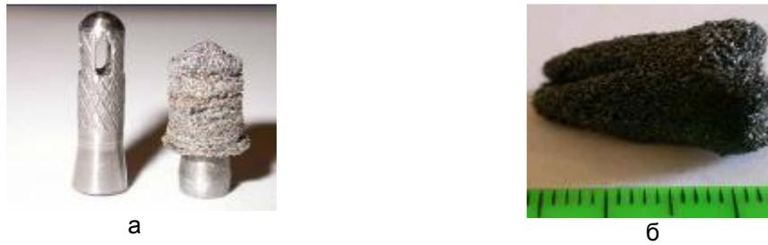
Рис. 3. Титановый имплантат с послойно наплавленным порошковым титановым покрытием (а) и модель коренного зуба, спеченного из металлического порошка (б)
