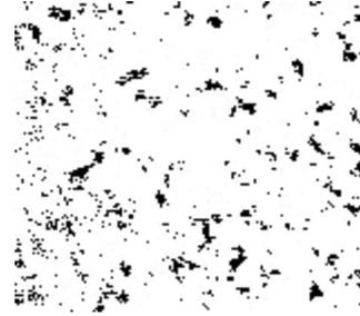
Рис. 4. Поры на поверхности оксидного покрытия (результат обработки изображения поверхности с помощью АГПМ-6М)
