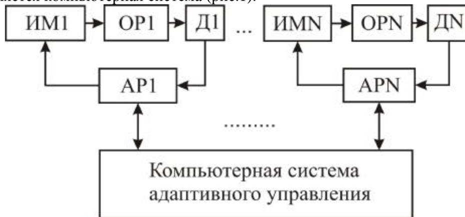
Рис. 1. Структурная схема компьютерной адаптивной системы управления: ИМ1...ИМN – исполнительные механизмы; OP1...OPN – объекты регулирования; Д1...ДN – датчики; AP1...APN – локальные автоматические регуляторы
