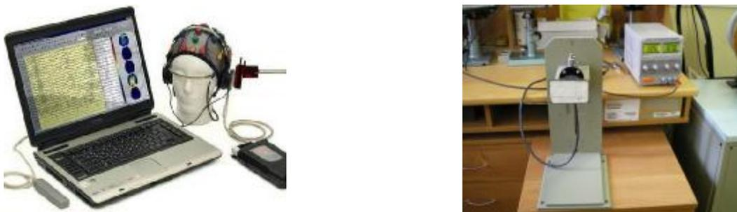
Рис 2. Схема установки «СПЭГ-НСФТ» в ходе эксперимента и общий вид выносного датчика автодина, снабженного рупорной антенной
