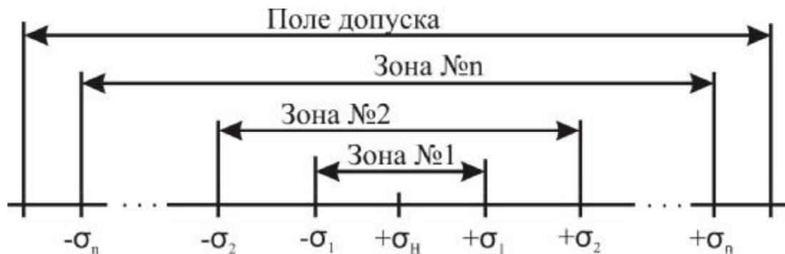
Рис. 6. Диаграмма отклонения прочности сцепления от значения:  $\sigma_n$  – номинальное значение прочности сцепления покрытия с основой.
