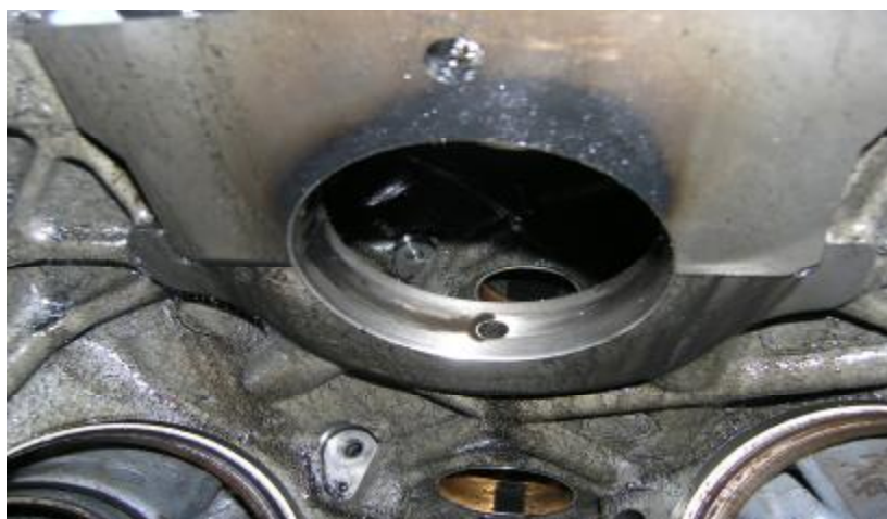
Рис. 1. Износ постели блока в результате перегрева сопряжения и проворачивания коренного подшипника
