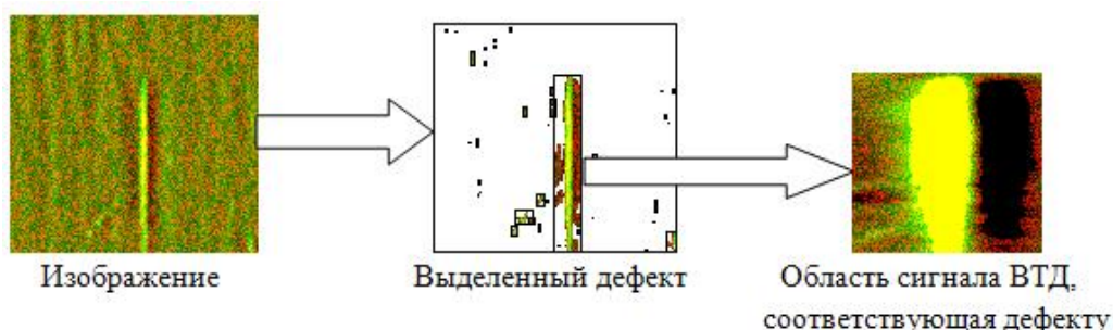
Рис. 2. Процедура обработки изображения поверхности изделия с дефектом
