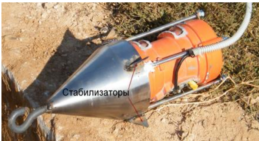
Рис. 2. Общий вид вибрационного рабочего наконечника со стабилизаторами на цилиндрической части
