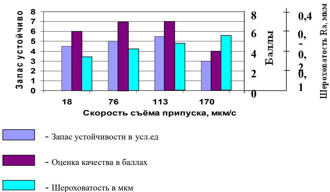
Рис.4. Связь скорости съема припуска с качеством обработки поверхности на шлифовальном станке SIW-4
