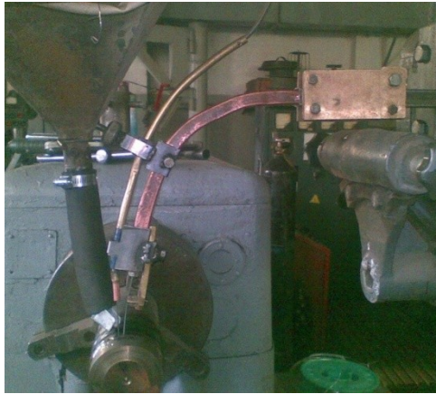
Рис. 2. Общий вид наплавочной головки с дополнительным подающим механизмом
