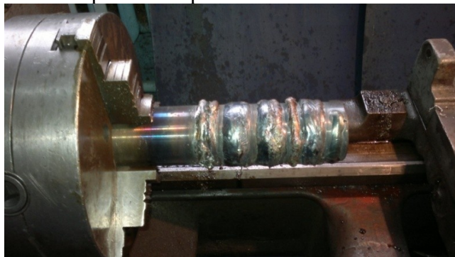
Рис. 4. Общий вид интерметаллидных покрытий до токарной обработки
