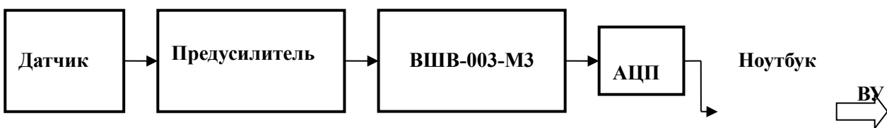
Структура ИИК динамического состояния оборудования
