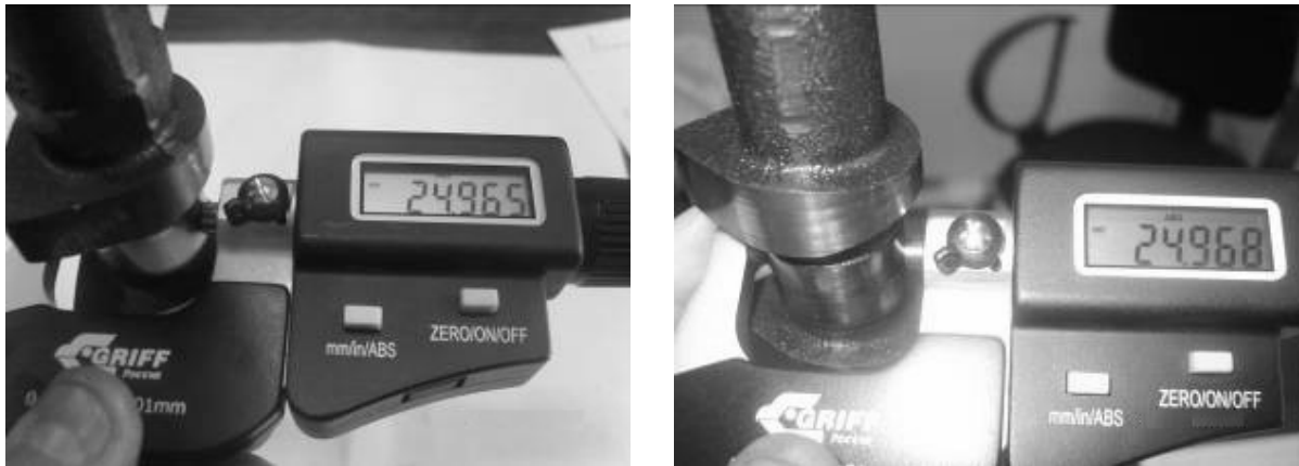
Рис. 7. Измерение диаметров опорных шеек распределительных валов МГР
