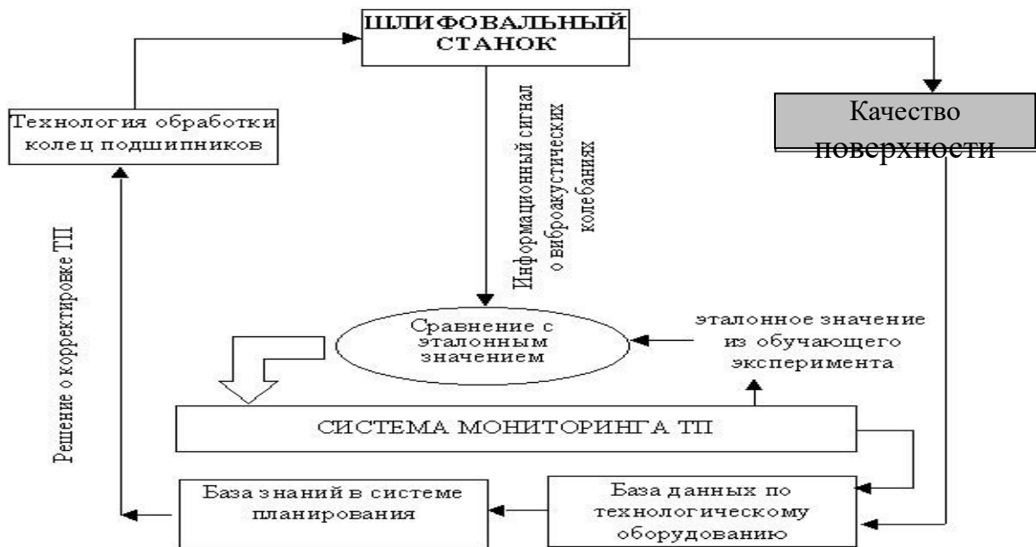
Рис. 3. Схема формирования автоматизированной оценки динамического состояния станка
