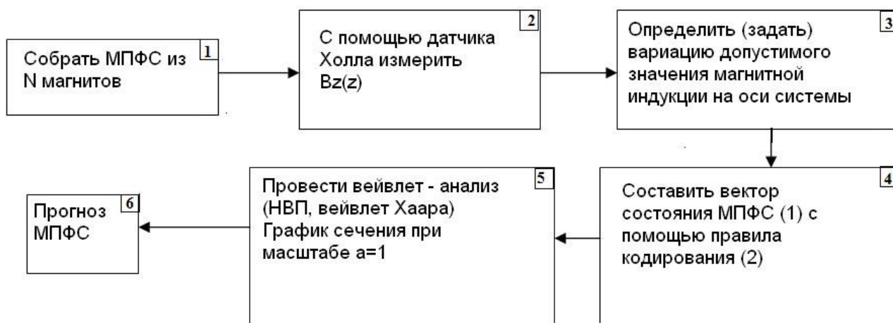
Рис. 2. Процесс диагностики МПФС
