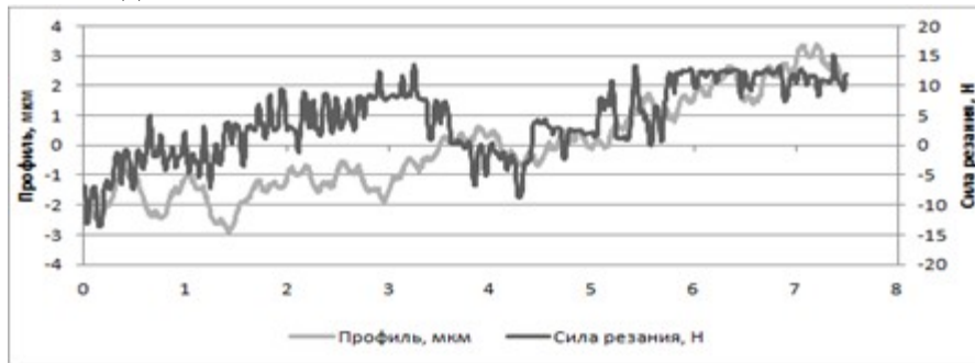
Рис. 6. Графики силы резания в процессе точения и полученного продольного профиля поверхности образца
