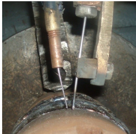
Рис. 3. Общий вид наплавочной головки с плавно изменяемым расстоянием относительно основного электрода
