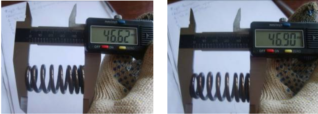
Рис. 3. Измерение длины клапанных пружин МГР I цилиндра в свободном состоянии
