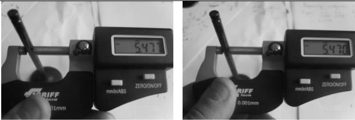
Рис. 5. Измерение диаметра стержней клапанов МГР I цилиндра
