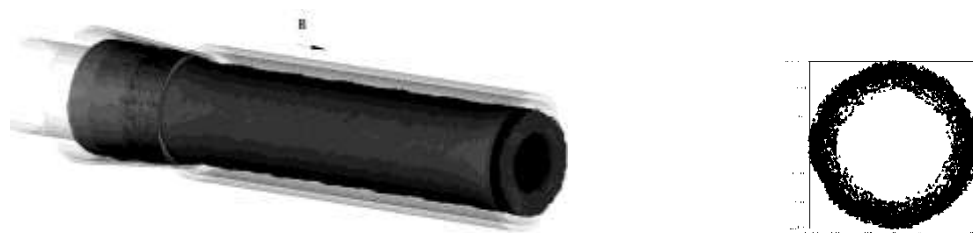
Рис. 2. Компьютерные изображения трубчатого электронного потока и его структуры в поперечном сечении
