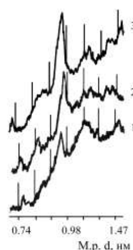
Рис. 5. Фрагменты дифрактограмм образцов, модифицированных рибозой: 1 – 1 сутки гидратации; 2 – 7 сутки гидратации; 3 – 35 сутки гидратации.
