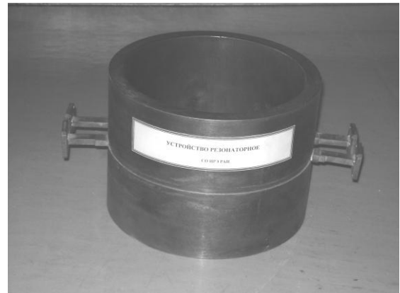
Рис. 4. Внешний вид открытого цилиндрического резонатора с волноводной системой возбуждения и приема СВЧ зондирующего излучения
