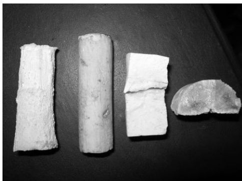
Рис. 2. Образцы спеченной в СВЧ электромагнитном поле керамики оксида цинка
