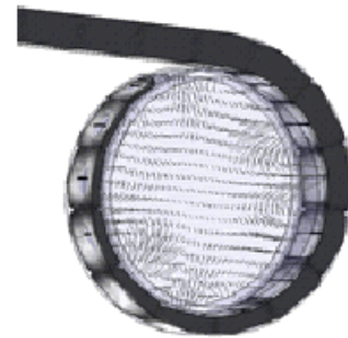
Рис. 10. Распределение напряженностей электрических полей в СВЧ реакторе с переменной высотой узкой стенки опоясывающего волновода
