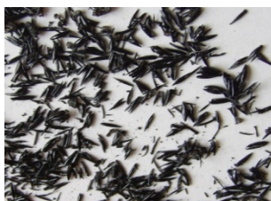
Рис. 1. ООП, термообработанные при T = 400^\circ\text{C} в течение 5 мин
