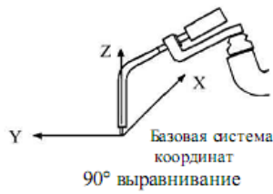
Рис. 2. Базовая система координат робота точечной сварки 90° выравнивание
