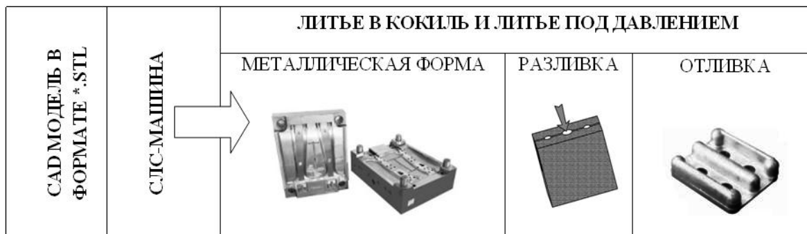
Рис. 5. Условная схема применения СЛС в процессе литья в кокиль и литья под давлением (прямое изготовление металлической формы) [5]
