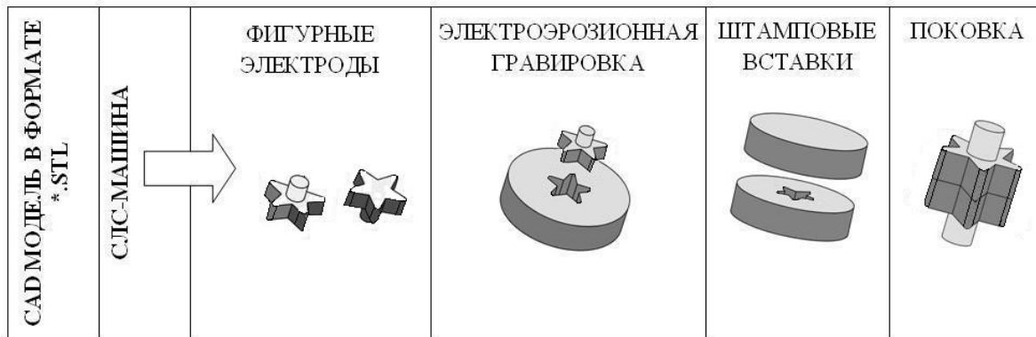
Рис. 6. Условная схема применения СЛС в процессе горячей объемной штамповки (изготовление сложнопрофильных электродов) [5]
