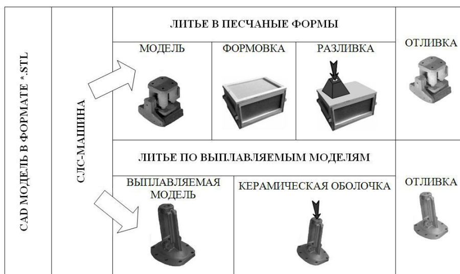
Рис. 3. Создание шаблонной модели методом СЛС и использование ее в литье в песчаные формы и в литье по выплавляемым моделям [5]
