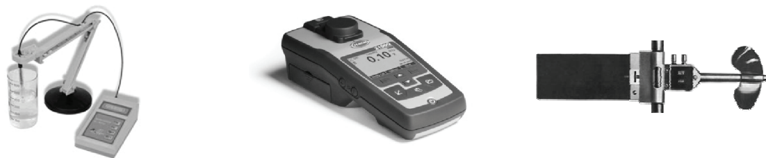
а – микропроцессорный иономер б – портативный мутномер в – гидрометрическая вертушка
