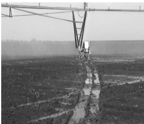
Рис. 2. Шагающая опора дождевальной машины
