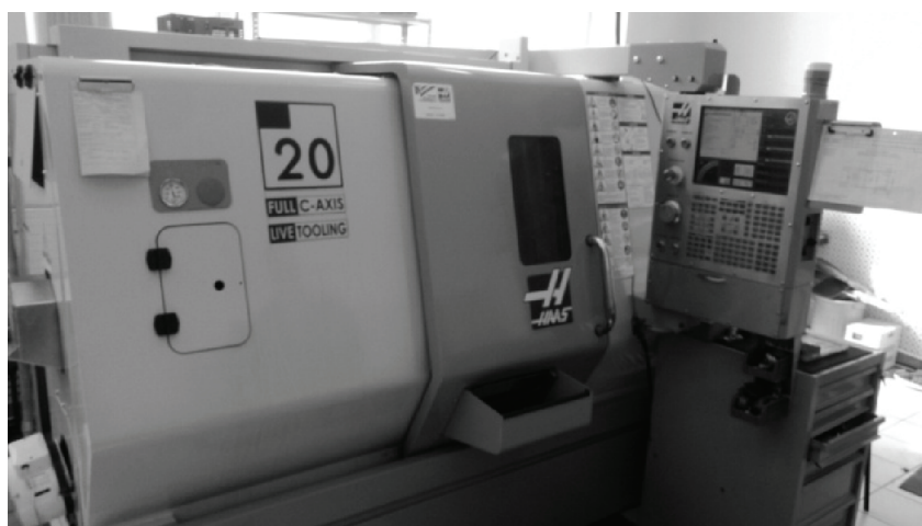
Рис. 1. Токарно-револьверный центр с ЧПУ Модель SL-20HE, производство фирмы HAAS AUTOMATION Inc.
