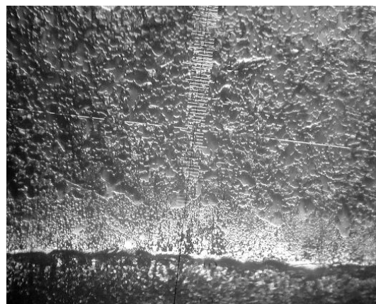
Рис. 2. Фотография шлифа поверхностного слоя контакта ВДК после ресурсных испытаний
