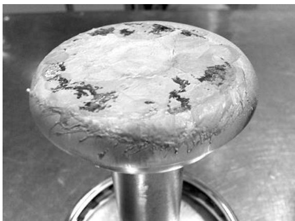
Рис. 1. Фотография рабочей поверхности контакта ВДК после ресурсных испытаний
