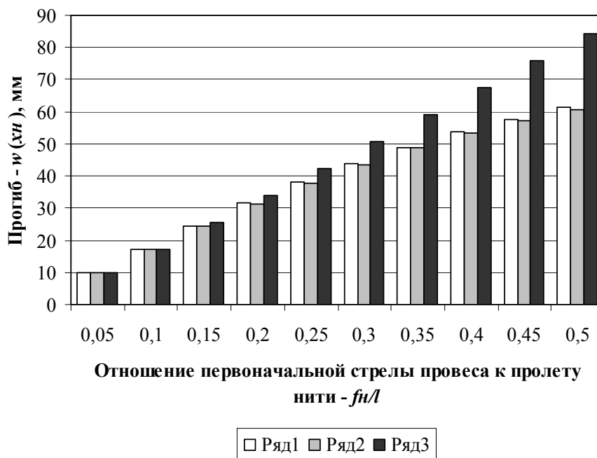
Рис. 5. Гистограмма зависимости прогиба w(x_H) от отношения первоначальной стрелы провеса к пролету нити f_H/l : Ряд 1 – предложенная методика; Ряд 2 – метод конечных элементов; Ряд 3 – методика В.К. Качурина
