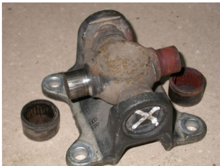
Рис. 7. Внешний вид изношенных деталей («ложное бринелирование») подшипникового узла крестовины
