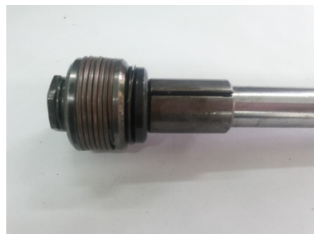
Рис. 10. Конструкция поршня с уплотнением из винтовой цилиндрической пружины квадратного сечения с поджатыми витками
