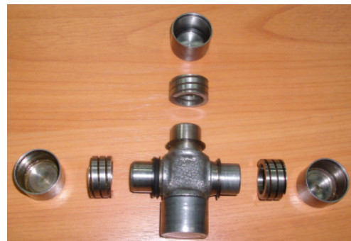
Рис. 8. Модернизированные крестовины автомобиля ВАЗ «Нива»
