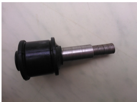
Рис. 9. Сайлентблок амортизатора новой конструкции с пружинным вкладышем
