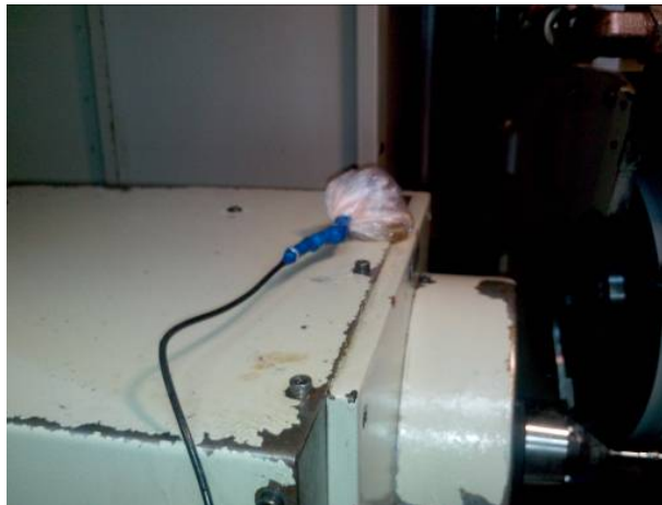
Рис. 1. Вибродатчик установлен на шпиндельном узле детали
