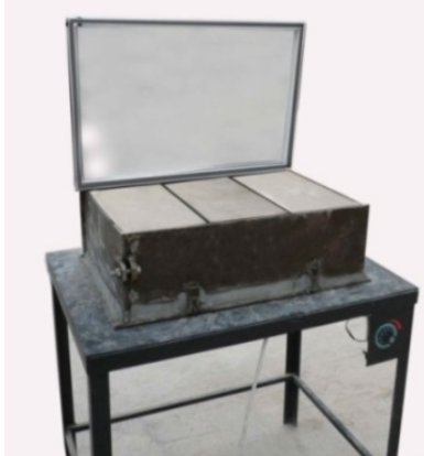
Рис. 1. Лабораторное оборудование, оснащенное гелиокрышкой и электроподогревом формы
