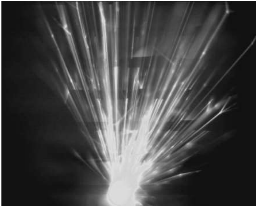
Рис. 1. Форма лазерного факела при наносекундной длительности импульса
