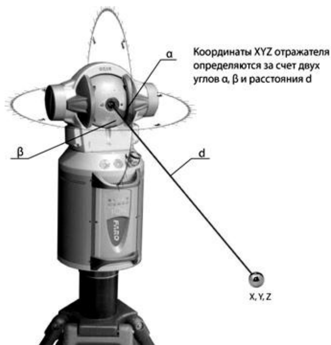
Рис. 1. Принцип работы лазерного трекера
