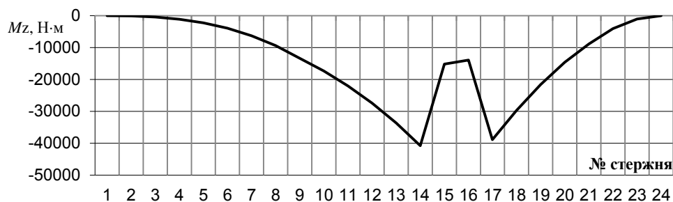
Рис. 5. Эпюра изгибающих моментов действующих на негабарит в захвате
