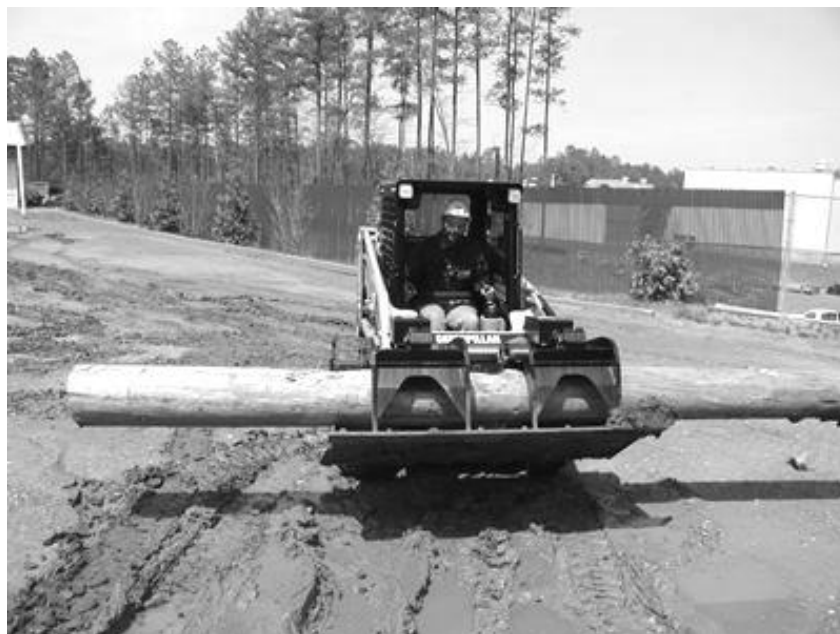
Рис. 1. Демонстрация применения челюстного захвата [4]
