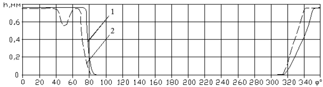
Рис. 2. Диаграмма движения запорного элемента самодействующего нормально открытого прямооточного клапана ДКА: (Спл = 740 Н/м; h_{\max} = 0,7 мм) 1 – эксперимент; 2 – расчет
