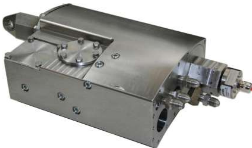
Рис. 3. Опытный образец электропневмогидравлического рулевого привода автономного подводного аппарата
