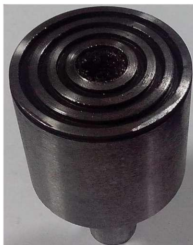
Рис. 8. Фотография торца ролика после испытаний
