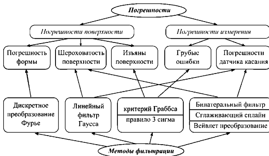
Рис. 1. Связи погрешностей и методов фильтрации
