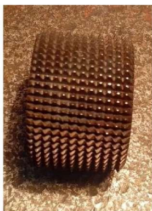
Рис. 2. Фотография ролика с шипами
