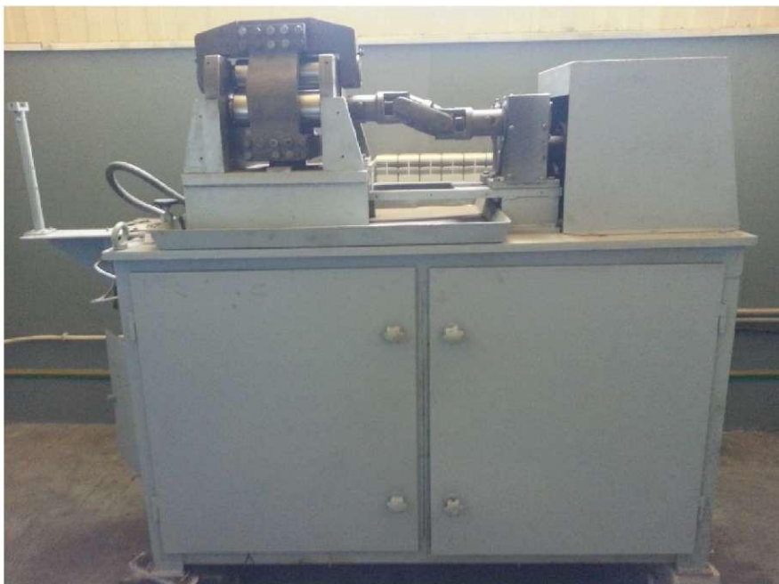
Рис. 3. Фотография автомата для микродинамической релаксации остаточных напряжений колец подшипников
