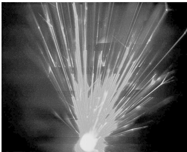
Рис. 1. Форма лазерного факела при наносекундной длительности импульса
