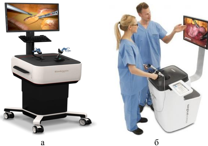
Рис. 4. Виртуальные тренажеры: а – симулятор LAP Mentor III; б – симулятор LapSim
