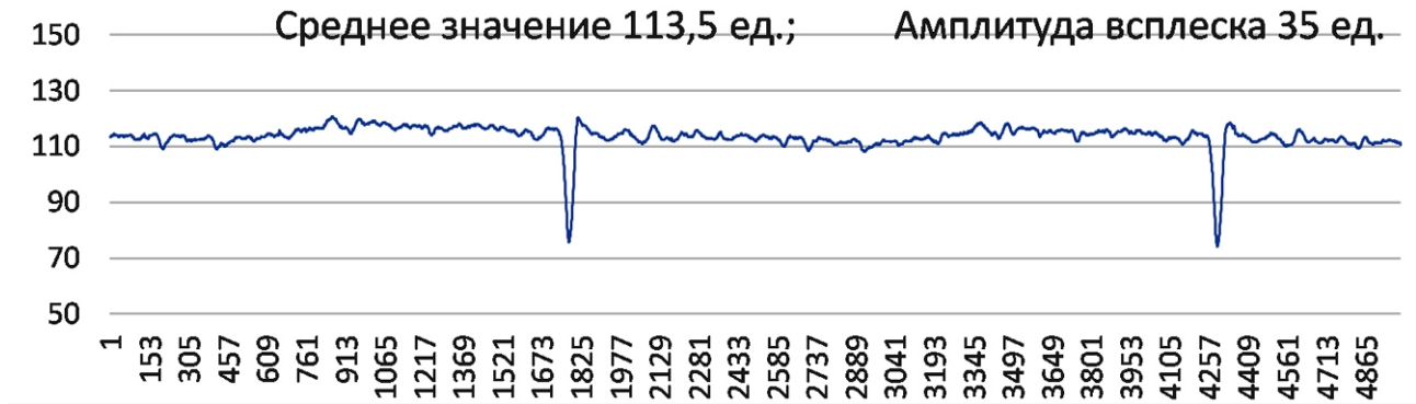
Рис. 6. График сигнала от поверхности контрольного образца с искусственным дефектом глубиной 35 мкм
