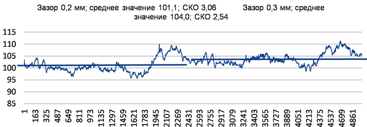
Рис. 5. Зависимость сигнала вихретокового преобразователя от измерительного зазора (сплошной линией показана постоянная составляющая сигнала)
