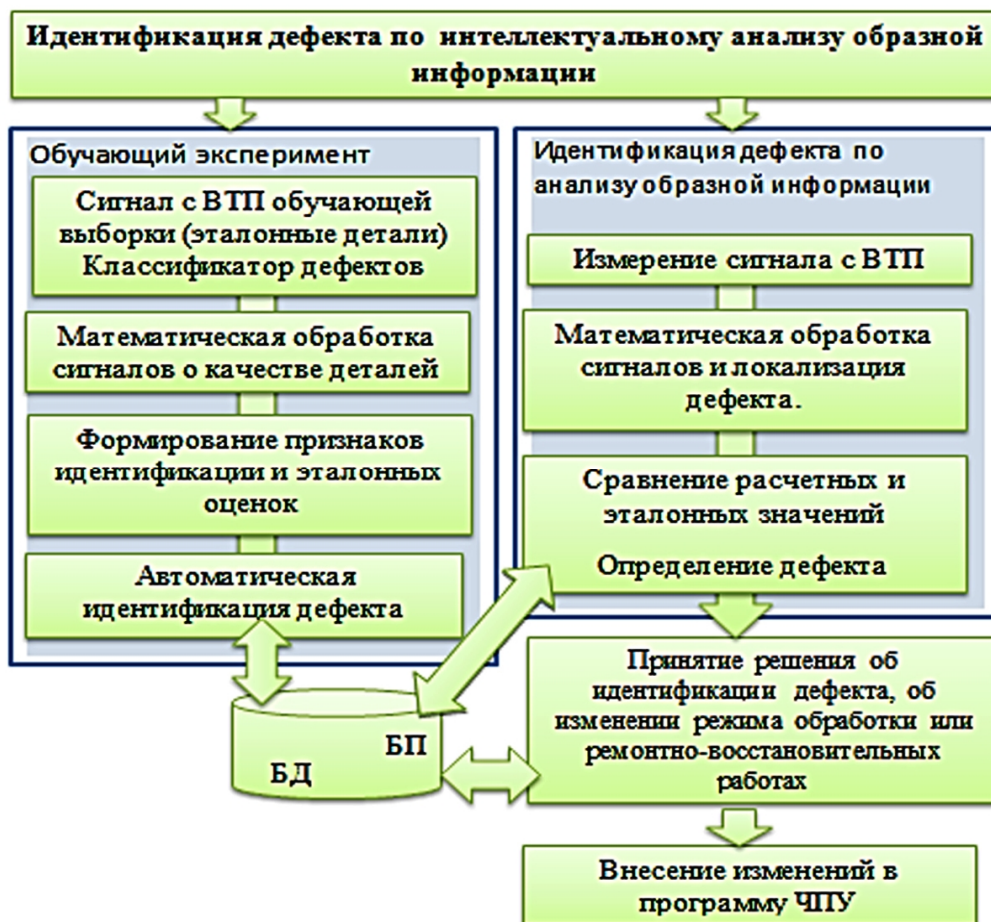
Рис. 1. Алгоритмизация идентификации дефектов шлифования деталей по интеллектуальному анализу образной информации
