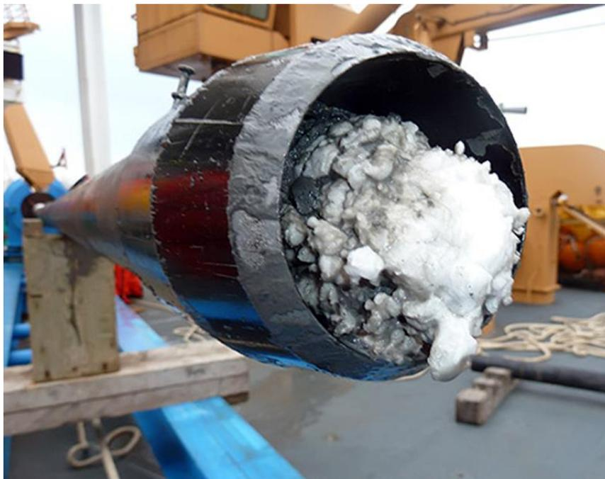
Рис. 1. Образование ледяных пробок в газопроводе
