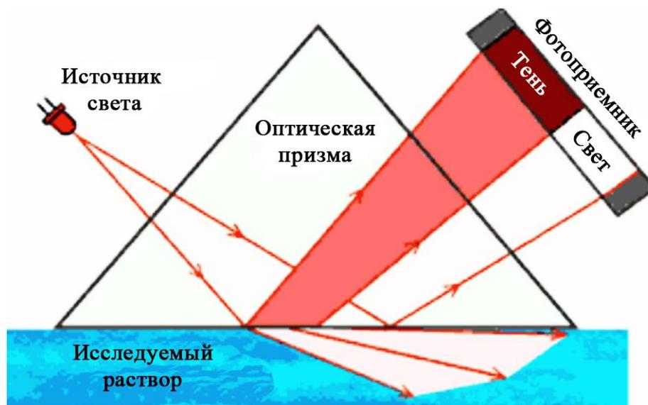
Рис. 4. Рефрактометрический метод определения концентрации раствора
