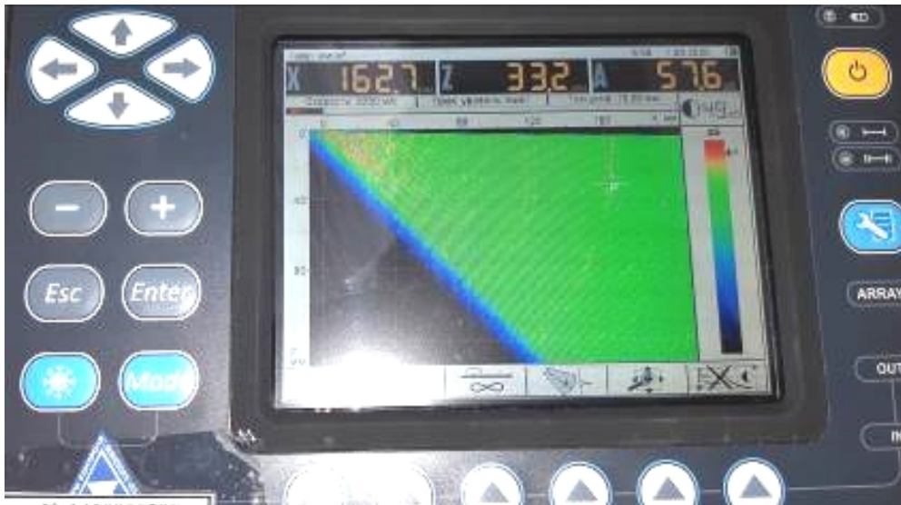
Рис. 1. Изображение фокусного пятна от угла торца ответвления прямой врезки на расстоянии 162,7 мм от АР
