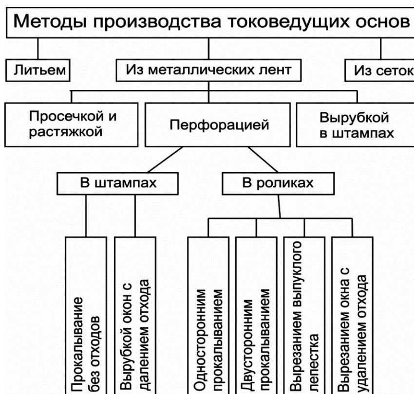
Рис. 1. Схема классификации методов производства токоведущих основ электродов
